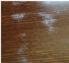
普通水性2K面漆划伤测试后 Normal W/B 2K topcoat
