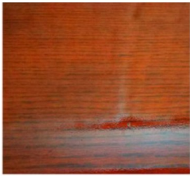
Lacper® 4703面漆划伤测试后 Lacper® 4703 Topcoat
