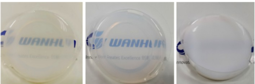
Lacper® 4221+ 10%Aquolin® 168 Lacper® 4221 Lacper® 4221+ 10%磺酸盐固化剂
